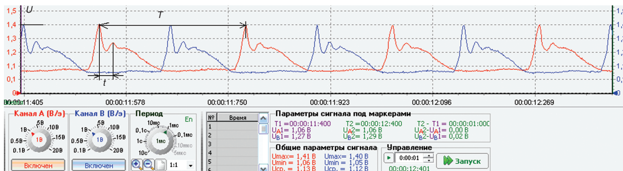
Рис. 6 Оциллограмма испытаний гидродемфера ВНВ на стенде С-2363 расшифровкой: T – период; скорость вращения эксцентрика n = 60/T ; люфт стенда в процентах определяется как соотношение t/T
